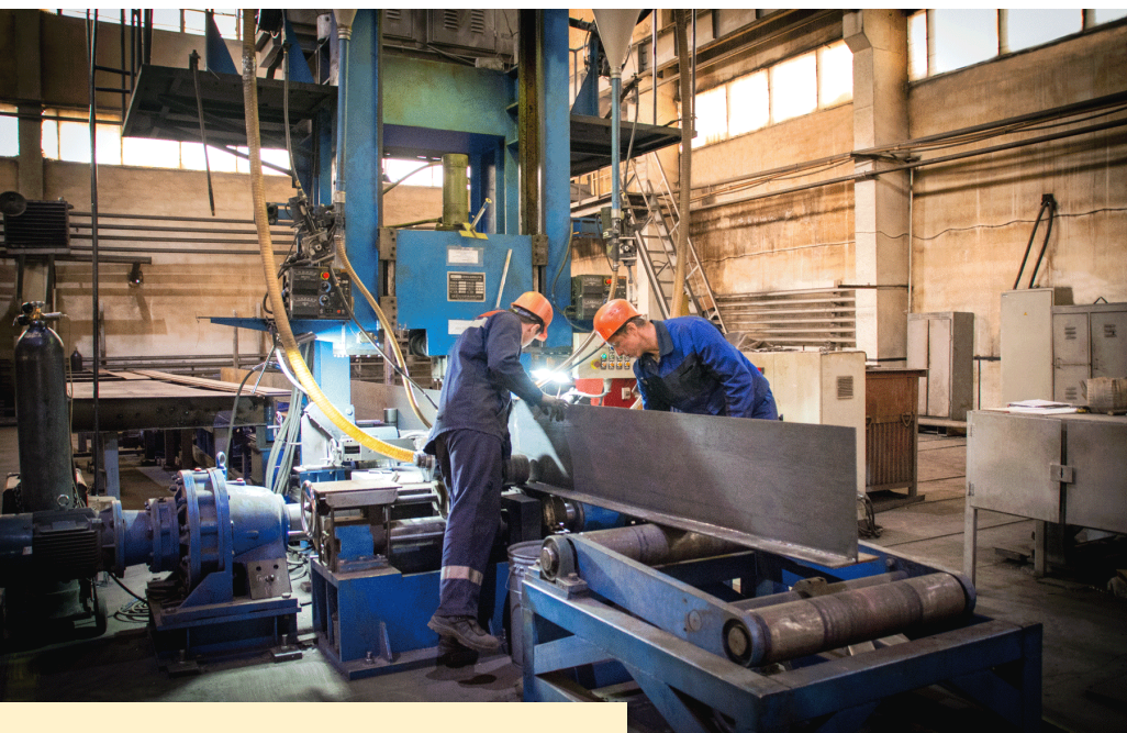
Универсальный сварочный стан ННХ1800
